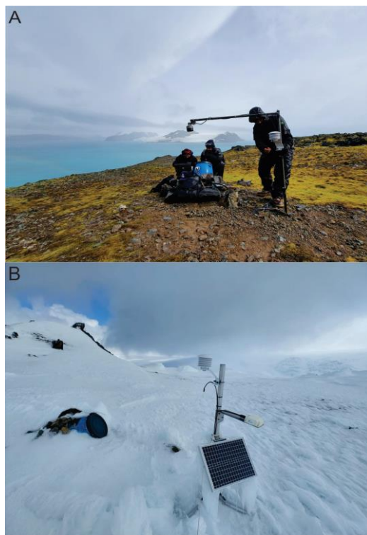
Figura 4. A) Manutenção de um sítio de monitoramento de temperatura do solo e do ar e umidade do solo; B) Sítio de monitoramento em pleno funcionamento no início do verão, retroalimentado por placa solar. (Fotografia de Marcio Francelino)
